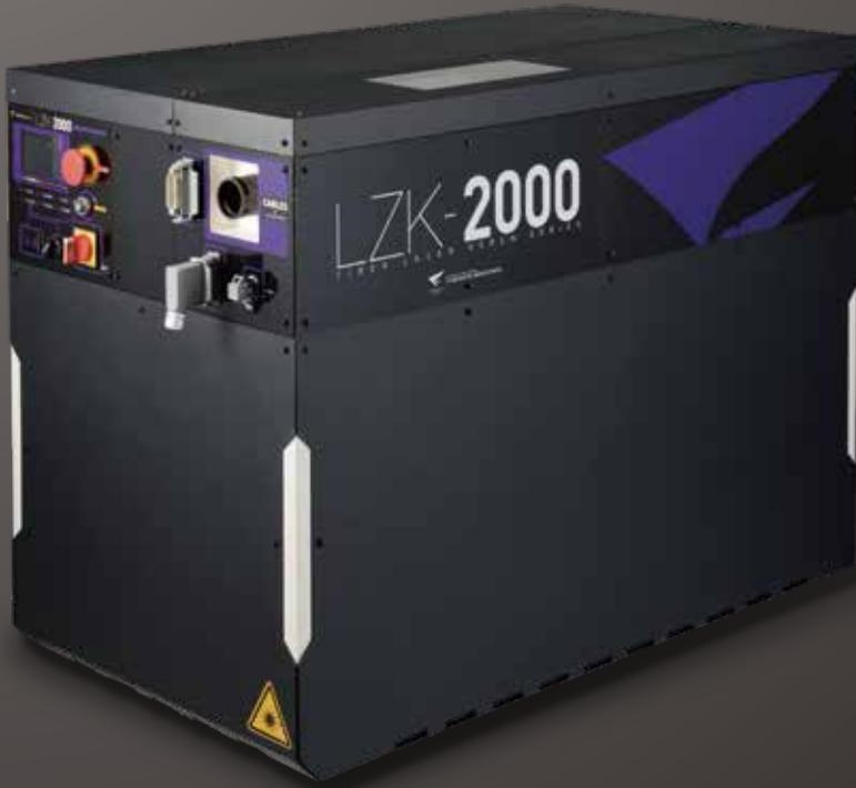
광섬유 레이저의 연속 빔(CW 레이저)을 재료 표면에선 모양으로 조사하여, 레이저 사출 건을 이동시키면서 가공하는 장비입니다. LaserKEREN® 저출력 타입에서 사용되는 펄스 발진 방식 레이저 보다 시간당 에너지량이 많아, 박리 대상의 두께가 두꺼운 경우나, 부식이 뚜렷한 재료 가공에 적합합니다. 광섬유를 사용한 여기 방식, 레이저 사출 스캔 방식, 사출 레이저의 파장은 저출력 타입인 LaserKEREN® 과 동일합니다.
